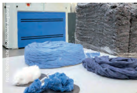
Aus getragenen Jeans wird neues Baumwoll-Garn wie an der ITA-Augsburg.
