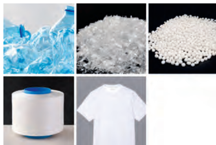
Aus PET-Flaschen werden über Flakes, Granulat und Garn Polyester-Shirts.
